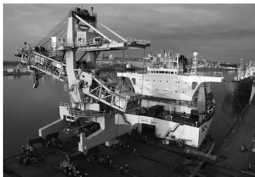
Le chargeur de navires du terminal de Beauport fait partie intégrante d'un système de manutention qui, en plus d'augmenter la productivité lors des chargements et des déchargements de marchandise en vrac, contribue à la réduction d'émissions de gaz à effet de serre.
