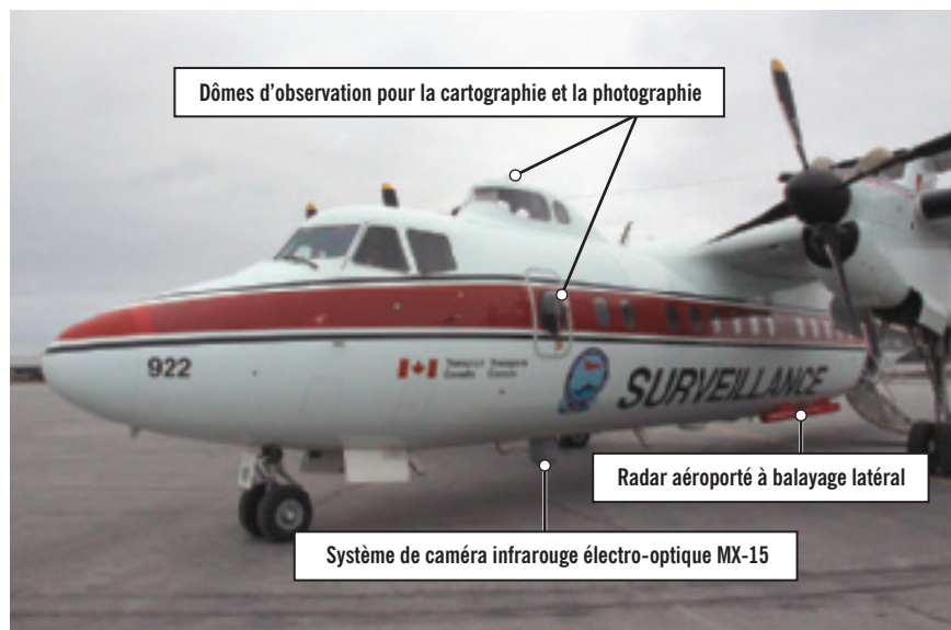
Pièce 3.7 L'avion Dash 7 du Programme national de surveillance aérienne est équipé pour réaliser des missions aux objectifs multiples
