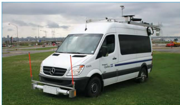
■ Véhicule de mesure de l'état des chaussées du ministère des Transports du Québec. Source : Ministère des Transports du Québec.
