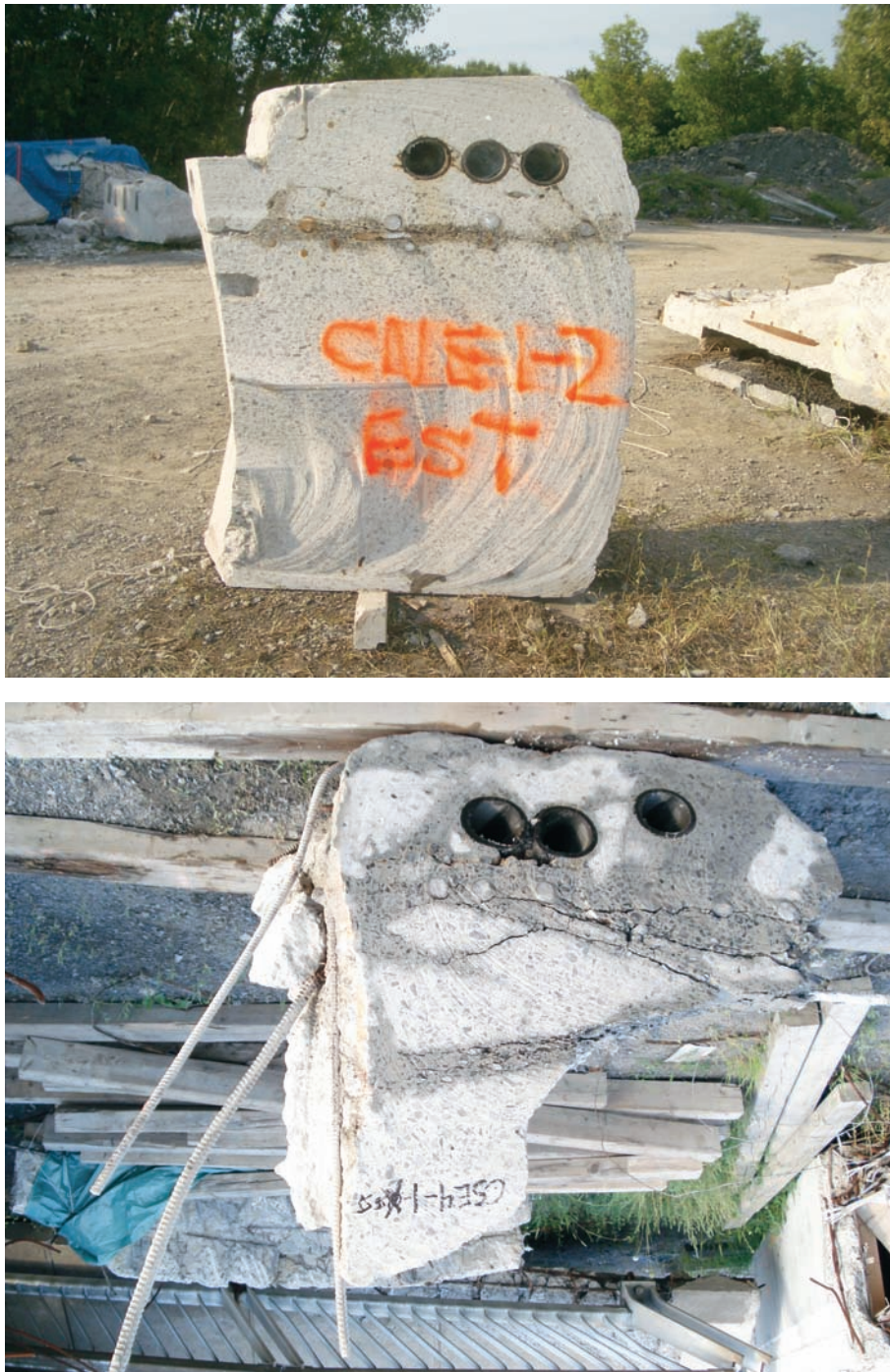
Figure 5.8 Coupes transversales partielles de la culée est réalisées lors des travaux de dissection complémentaire du mois d'août 2007 montrant les coins nord (en haut) et sud 105 (en bas)
