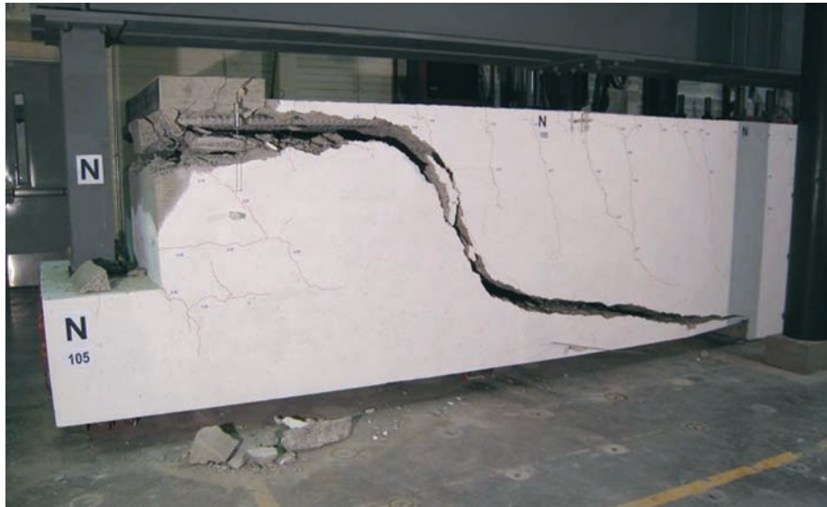
Figure 5.7 Rupture du porte-à-faux « tel que construit » lors des essais de chargement en laboratoire à l'Université McGill 90
