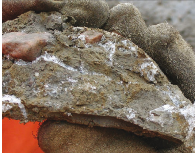
Figure 2 Lentilles de glace dans un sol gélif
