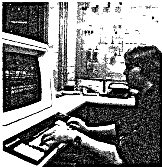
Des centres de contrôle électroniques comme celui de l'Industrielle à Pointe Ste-Foy seront de plus en plus utilisés par le ministère des Travaux publics et de l'Approvisionnement pour assurer la surveillance des équipements mécaniques et l'application des mesures d'économie d'énergie dans les édifices gouvernementaux.
