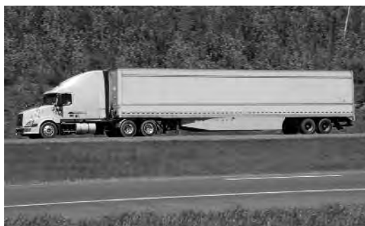
Tracteur semi-remorque équipé d'un ensemble aérodynamique et de jupes latérales permettant de réduire la consommation de carburant. Le Ministère soutient des projets visant la réduction des émissions de gaz à effet de serre.
