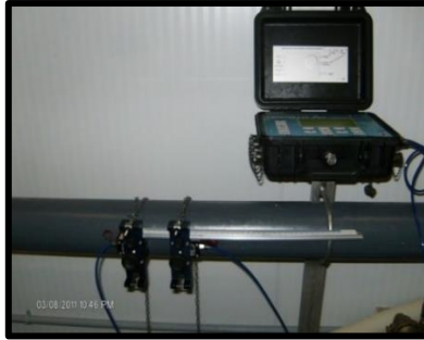
Figure 2. Débitmètre à ultrasons
