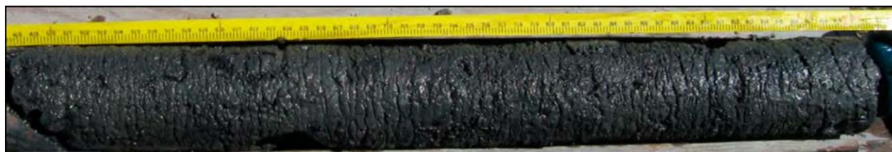
FIGURE 5.21 : GLACE DE SÉGRÉGATION DANS UN DIAMICTON INTERTIDAL HOLOCÈNE À TASIUJAQ (SOUS LA PISTE D'ATTERRISSAGE).
