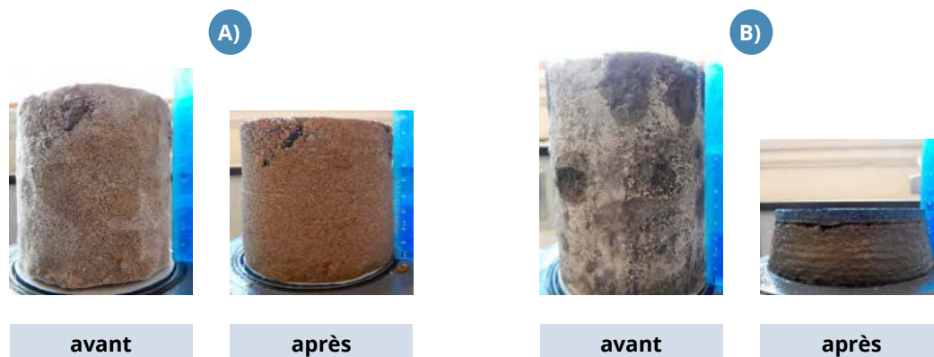
FIGURE 5.54 : ÉCHANTILLONS DE PERGÉLISOL A) PAUVRE EN GLACE ET B) RICHE EN GLACE SOUMIS À DES ESSAIS DE CONSOLIDATION AU DÉGEL (TIRÉ DE L'HÉRAULT ET AUTRES, 2015).
