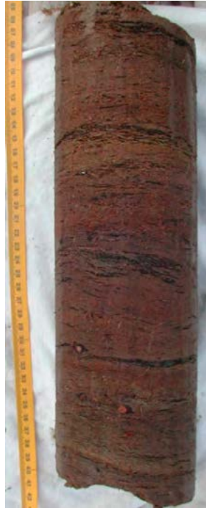
FIGURE 5.23 : TOURBE MINÉROTROPHE (COMPOSÉE PRINCIPALEMENT DE RESTES DE CYPÉRACÉES) GELÉE, FORÉE SUR UNE PALSE PRÈS D'UMIUJAQ. PERGÉLISOL ÉPIGÉNÉTIQUE, FORMÉ APRÈS LE DÉPÔT DE LA TOURBE. DE FINES LENTILLES DE GLACE DE SÉGRÉGATION ONT PU SE FORMER DANS CETTE TOURBE TRÈS DÉCOMPOSÉE ET EN PARTIE MINÉRALISÉE.
