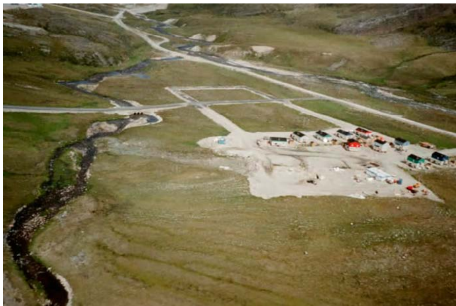
FIGURE 5.42 : UN GLISSEMENT DE TYPE DÉCROCHEMENT DE LA COUCHE ACTIVE, SURVENU À SALLUIT EN 1998, A CONDUIT À L'ABANDON DU DÉVELOPPEMENT DU NOUVEAU QUARTIER RÉSIDENTIEL ET AU DÉPLACEMENT D'UNE VINGTAINE DE MAISONS FRAÎCHEMENT INSTALLÉES.
