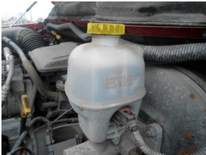
FIGURE 56 | Réservoir du maître-cylindre d'un camion
