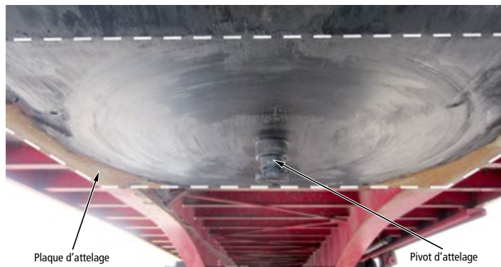
FIGURE 10 | Plaque d'attelage et pivot d'attelage
