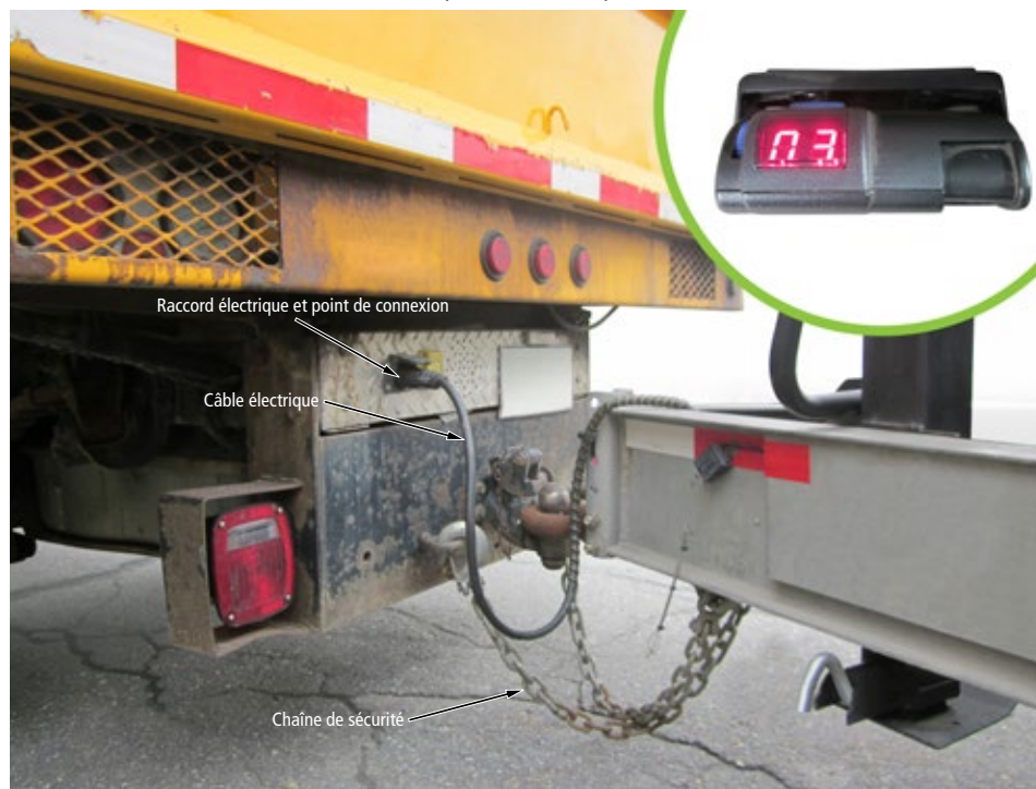
FIGURE 55 (en médaillon) | Contrôle d'intensité pour freins électriques
