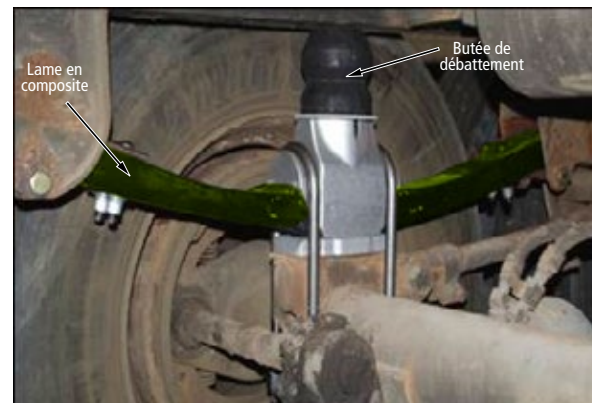
FIGURE 53 | Ressort à lame en composite
