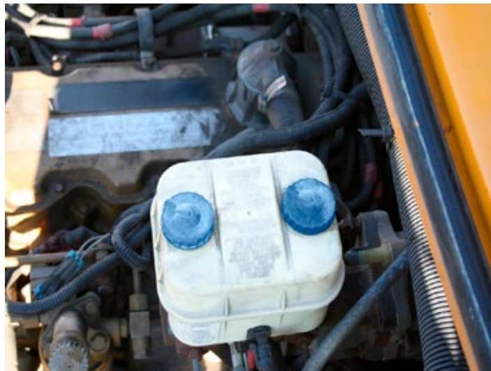
FIGURE 57 | Réservoir du maître-cylindre d'un autobus scolaire
