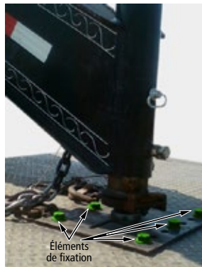
FIGURE 16 | Dispositif d'attelage col de cygne
