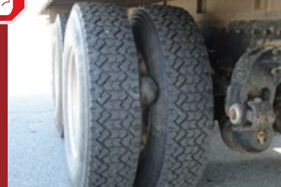
FIGURE 41 | Pneu présentant un renflement relié à un défaut de la carcasse
