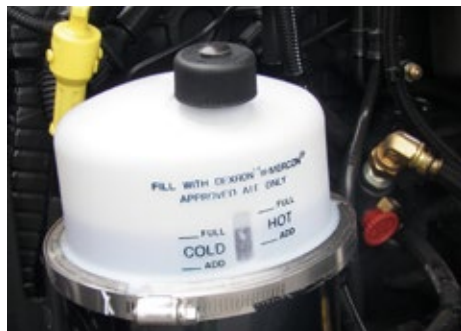
FIGURE 23 | Réservoir de la pompe de la servodirection
