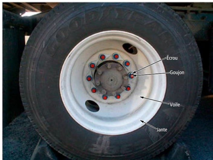
FIGURE 44 | Roue à disque ( budd wheel )
