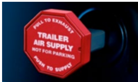
FIGURE 64 | Commande d'alimentation en air de la remorque
