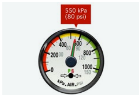
FIGURE 70 | Manomètre indiquant une pression de 550 kPa (80 lb/po 2 )
