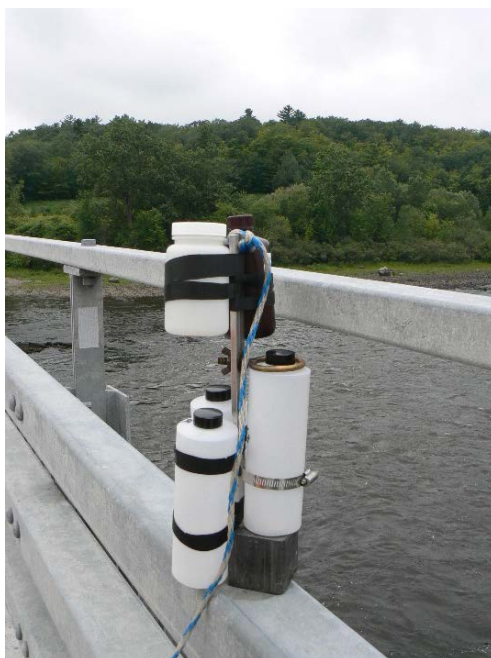
Figure 1 Porte-bouteilles utilisé pour échantillonner à partir d'un pont
