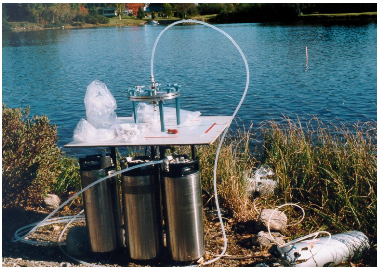
Figure 16 Matériel utilisé pour l'échantillonnage à grand volume
