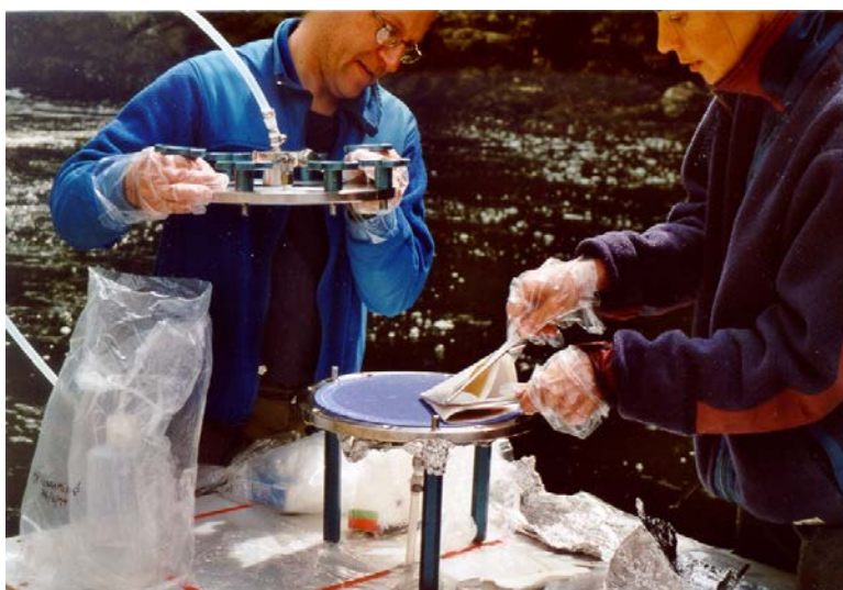
Figure 17 Filtration sur le terrain lors d'un échantillonnage à grand volume
