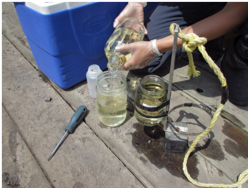
Figure 14 Transfert d'un échantillon pour l'analyse des pesticides dans une bouteille contenant un agent de conservation
