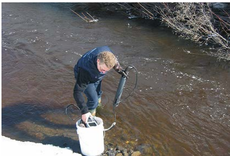
Figure 11 Mesure de paramètres in situ avec une sonde
