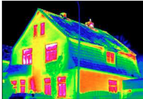
FIGURE XIV.1 : PHOTO INFRAROUGE D'UNE HABITATION PRISE EN HIVER. LE ROUGE REPRÉSENTE LES ÉLÉMENTS CHAUDS ET LE BLEU, LES FROIDS. / SOURCE : GOOGLE IMAGES
