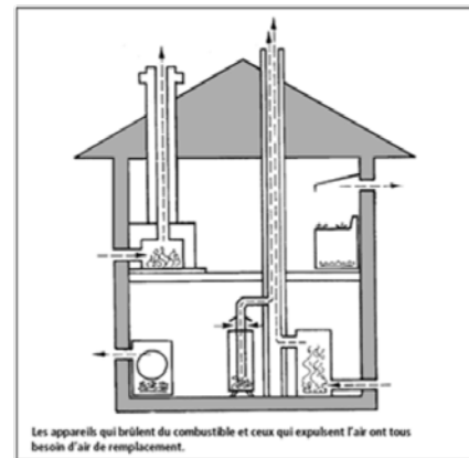
FIGURE VI.3 : ENTRÉES ET SORTIES D'AIR DANS UNE HABITATION / SOURCE : ARTICLE DU RNC INTITULÉ : « LE MÉCANISME DE VOTRE MAISON : VENTILATION ET CONTRÔLE DU FLUX D'AIR »
